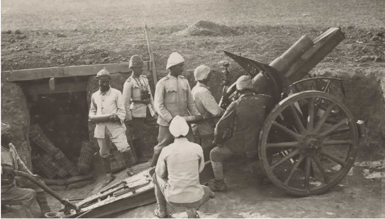
▲ Hureyra direnek noktasında mevziye girmiş 150 mm'lik Krupp s.F.H. 13/L14 kısa namlulu obüs ve mürettebatı.
