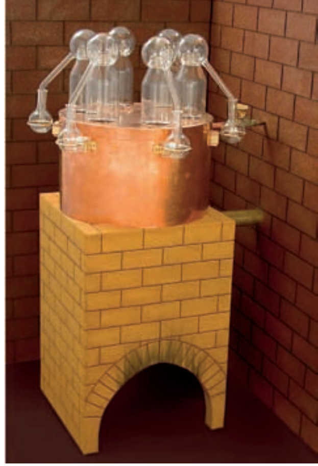
Modelimiz: Bakır ve ahşap, astarlanmış. 6 cam imbik. Toplam yükseklik 1,2 m. (Envanter No: K 1.63)
