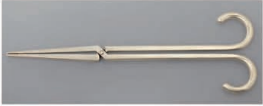
Modelimiz (c): Paslanmaz çelik hareket edebilir perçinlenmiş. Uzunluk: 144 mm. (Envanter No: H 9.20)
