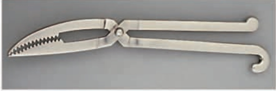
Modelimiz (b): Paslanmaz çelik hareket edebilir perçinlenmiş. Uzunluk: 144 mm. (Envanter No: H 9.19)
