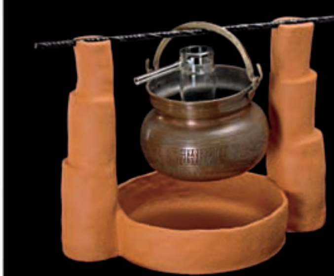
Modelimiz: Ocak: Pişirilmiş kil, yükseklik: 38 cm. Kazan: Bakır, hâkkedilmiş, çap 22 cm. İmbik kazanın içerisinde. (Envanter No: K 1.22)
