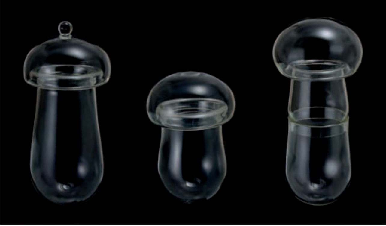
Modelimiz ( Alembic No. 6 ): Cam, renksiz. İki parça. Yükseklik: 19 cm. (Envanter No: K 1.33)
